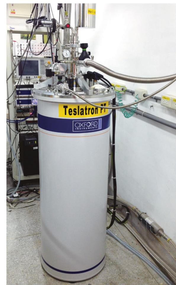
圖一：致冷機外觀。此台溫度可降到 0.3 K。致冷機上有許多線路連接到測量儀器上，另有幾條管線連接到幫浦或壓縮機（幫浦與壓縮機未顯示在照片內）。致冷機裡面則有超導磁鐵和待測樣品。（江佩勳教授實驗室提供）
